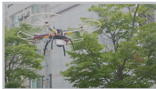
[ GPS와 LiDAR를 이용한 Drone Hovering ]
