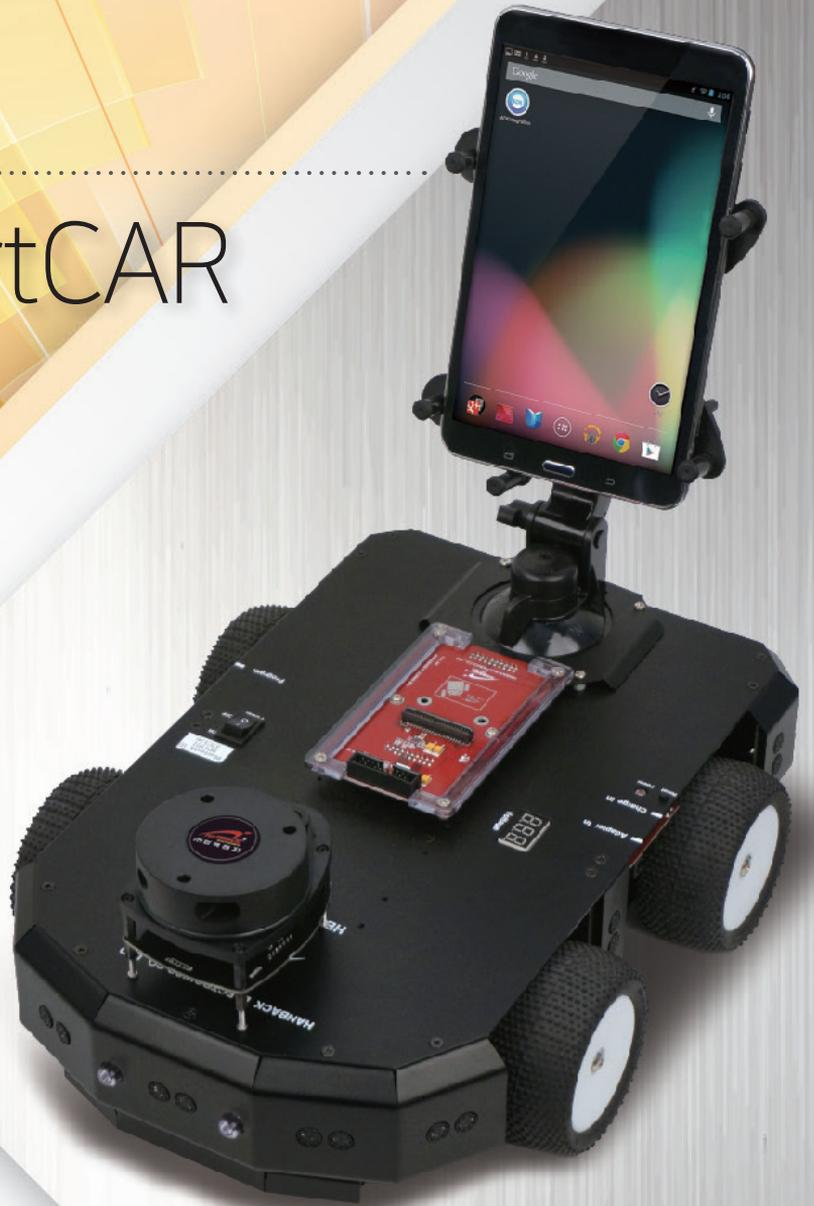
LiDAR SmartCAR는 LiDAR센서가 달린 차량용 로봇으로 LiDAR 및 각종 센서에 대한 교육과 자율 주행 그리고 ROS(로봇운영체제), SLAM(동시적 위치추적 및 지도작성)을 배울 수 있는 교육장비입니다.
