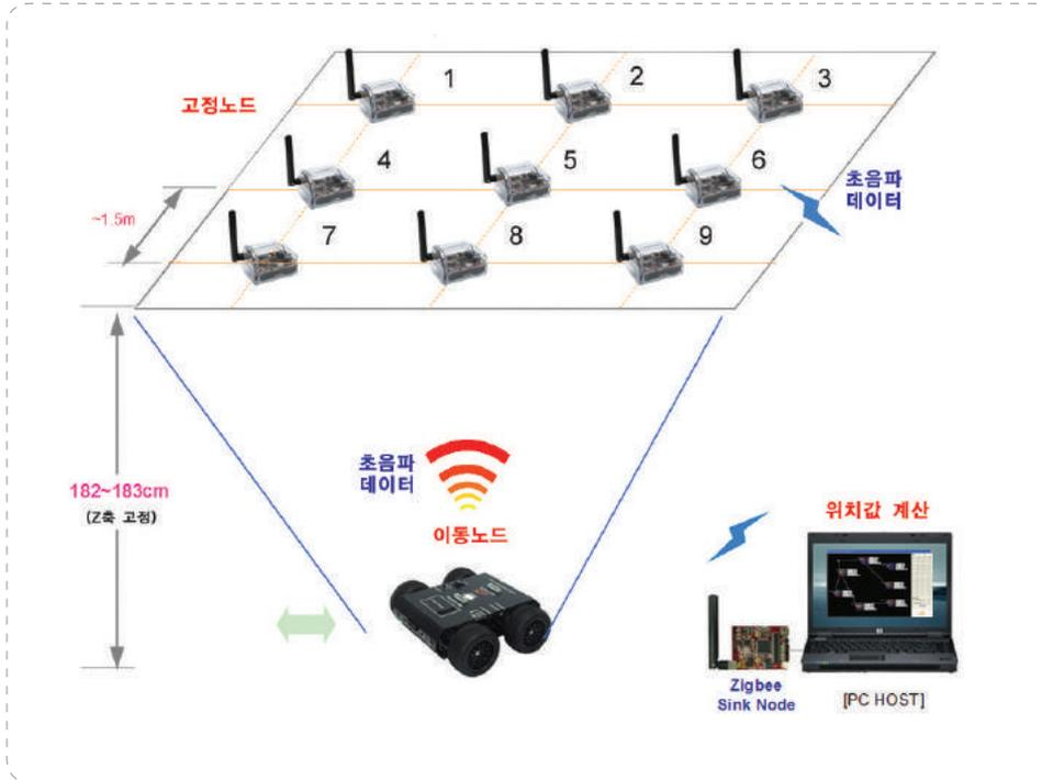
HBE-ZigbeX II + 초음파 센서 모듈을 이용한 실내 위치추적
